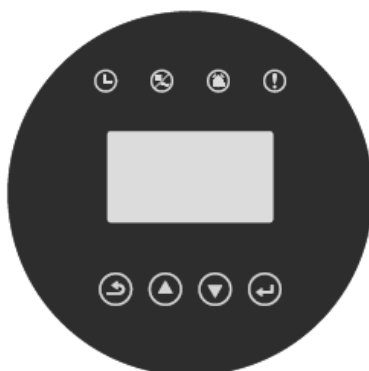
Рисунок 3.1 Дисплей на передней панели инвертора
